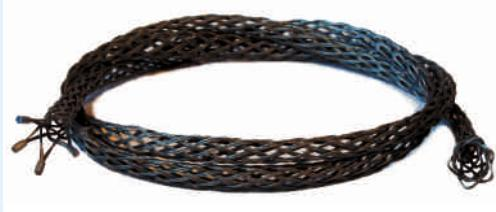
предназначен для временного захвата кабеля при замене существующей кабельной линии на новую. Новый кабель при помощи транзитного чулка крепится к заменяемому кабелю и при вытяжке старого кабеля одновременно происходит затяжка нового. Изготовлен из стального оцинкованного троса высокой износостойкости.
