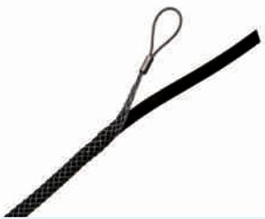
предназначен для временного захвата кабеля с боку, недалеко от торца кабеля, при проведении работ по прокладке кабеля в траншеях, колодцах, трубах кабельной канализации. Изготовлен из стального оцинкованного троса высокой износостойкости.
