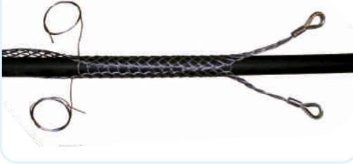
предназначен для временного захвата кабеля в любом месте на всем его протяжении при проведении работ по прокладке кабеля в траншеях, колодцах, трубах кабельной канализации. Он может быть использован как вспомогательный на промежуточных участках при открытом доступе к кабелю, а также для подтяжки кабеля в конкретном месте. Изготовлен из стального оцинкованного троса высокой износостойкости.
