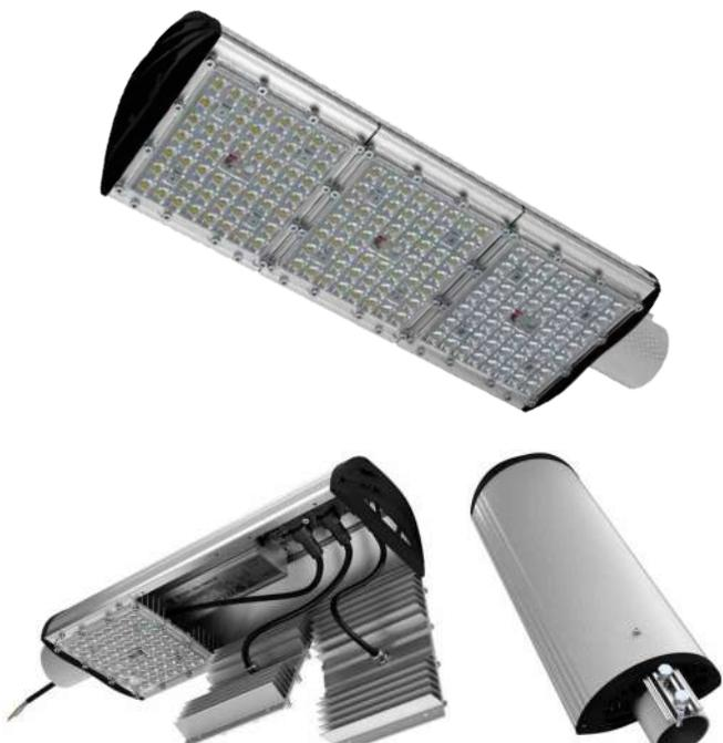
Светодиодные светильники «K-LIC-MLC» имеют самую высокую световую эффективность (до 174 лм/Вт) среди подобных решений на рынке. Внешняя сторона светильника цилиндрическая, без рёбер – не скапливается пыль, листва и снег. Светильники предназначены для установки на консоль. Оптическая линза позволяет добиться высокой эффективности освещения дорожного полотна при установке на высоких опорах. Светильники подойдут для замены устаревших светильников с лампами ДРЛ 125-700 и ДНаТ 70-400.
